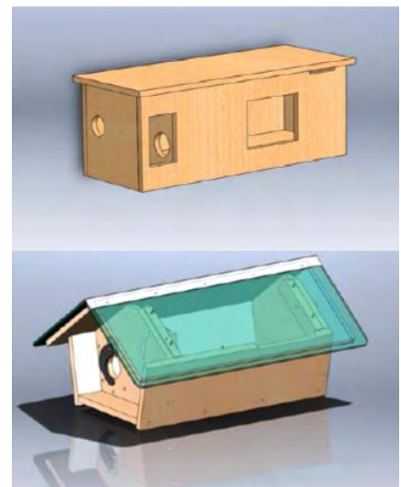
Figuur 6.2. Twee voorbeelden van steenuilkasten. Bij de onderste heeft de steenmarter geen toegang tot de broedruimte. Zie www.steenuil.nl voor bouw instructies.
