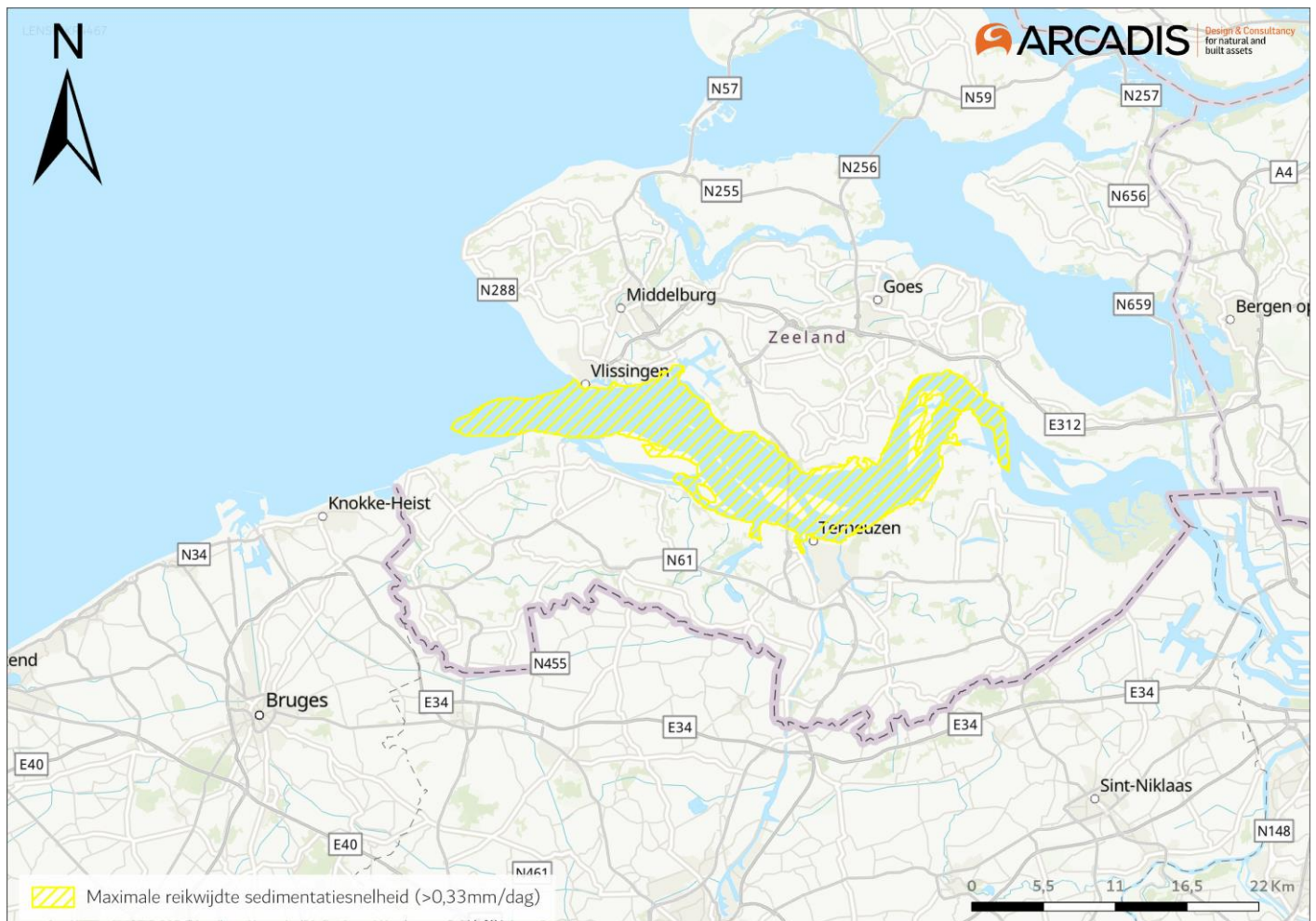
Figuur 4-4 Maximale reikwijdte sedimentatiesnelheid (>0,33mm/dag) als gevolg van de baggeractiviteiten in de winterperiode.
