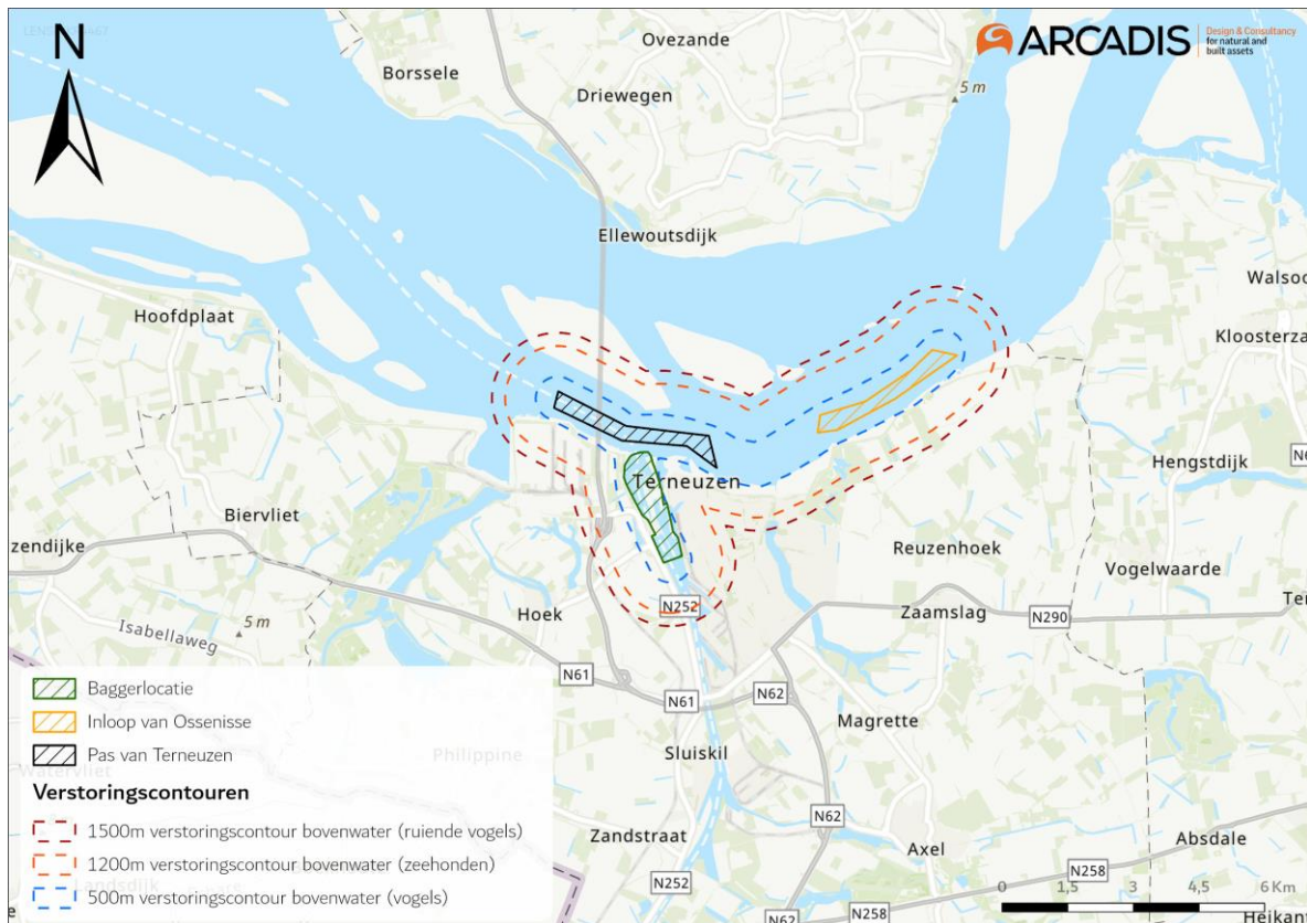
Figuur 4-7 1500m, 1200m en 500m verstoringscontour voor respectievelijk ruiende broedvogels, zeehonden en niet ruiende broedvogels rondom de vaarroute van de baggerlocatie naar de Pas van Terneuzen en de Inloop van Ossensisse.
