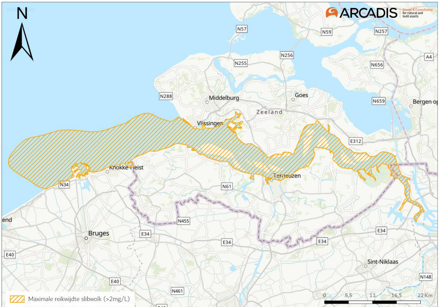
Figuur 4-1 Maximale reikwijdte slibwolk (>2mg/L).
